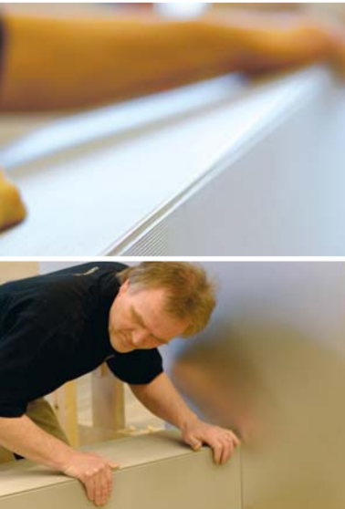
Bengt Andersson gör inpassning av trappsteg i aluminium.
