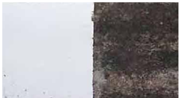
PROV FRÅN TESTMILJÖ DÄR VÄNSTRA YTHALVAN HAR GENOMGÅTT SAMMA ANTISEPTISKA PROCESS SOM ANTIBACTIRAIL. BILDEN ÄR TAGEN ETT ÅR EFTER BEHANDLING.
